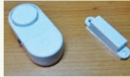
Şekil 6: Elektronik kısım ve mıknatıs
