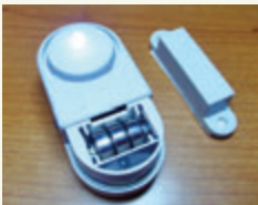
Şekil 16: Mıknatis uzakta iken LED yanar
