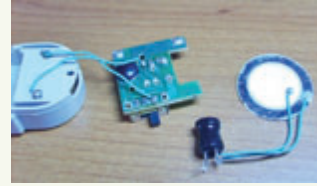
Şekil 10: Buzzer ve bobinin sökülmesi
